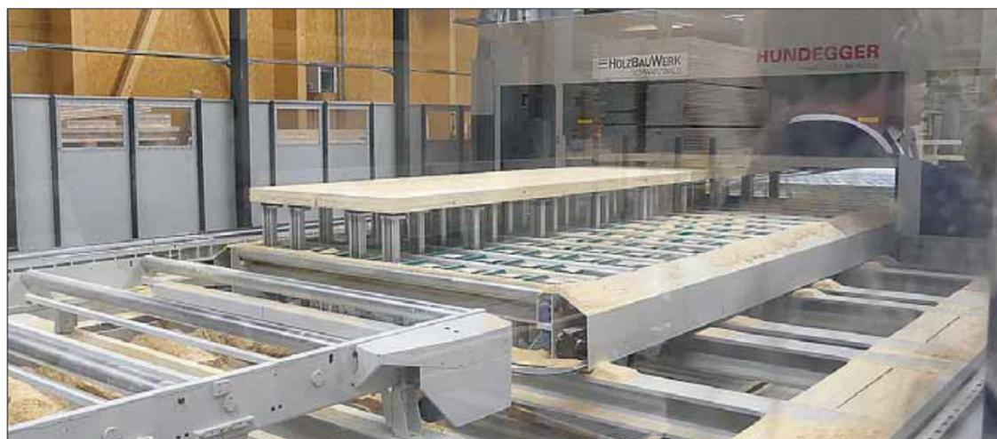
Der für HBW erstmals von Hundegger installierte Vakuumtisch mit 250 Vakuumstempeln ermöglicht die Bearbeitung eines Bauteils innerhalb des Plattennestings an den Plattenkanten und sogar im Randbereich auf der Plattenunterseite.
