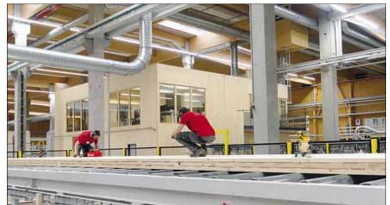
Visuelle Prüfung der Oberflächenqualität und manuelles Ausbessern nach dem ersten Schleifgang
